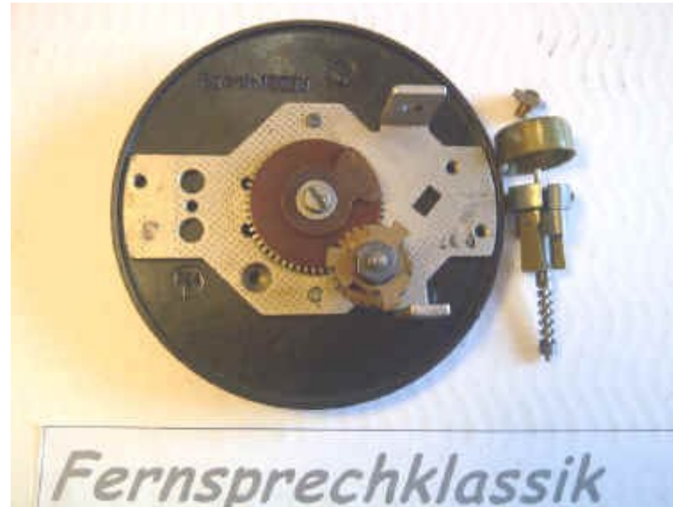
(Abb. 10: Die Bügelfeder ist in die Bremsbacken eingehakt)
