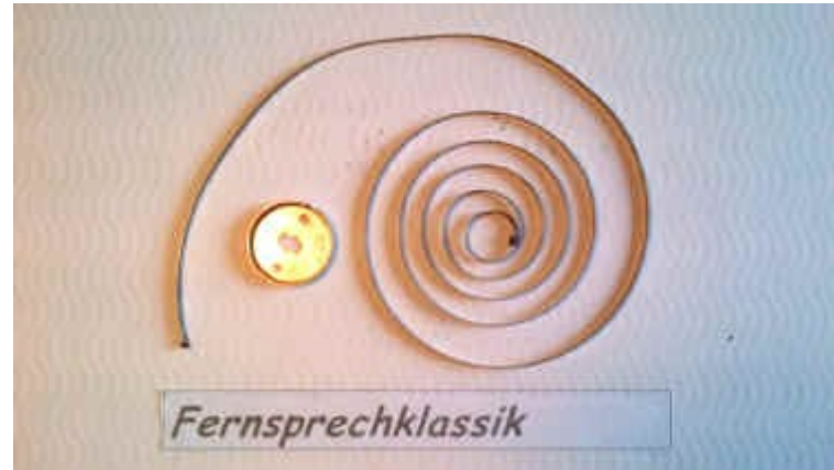
(Abb. 3: An diesen Arbeitsschritt habe ich mich erst heranwagen müssen, als die Feder beim unachtsamen Auseinanderbauen eines Schalters ihre Spannung einbüßte. Bis dahin hatte ich diese beiden Teile nicht voneinander getrennt. Gereinigt hatte ich diese Bauteile bis zu diesem Zeitpunkt so gut es ging in einem Waschbenzinbad.)
