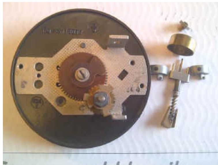
(Abb. 9: Von unten nach oben - Bügelfeder, Schnecke, zwei Bremsbacken mit je einem Bremsstift, Gehäuse und schraubbare Aufnahme mit Kontermutter)
