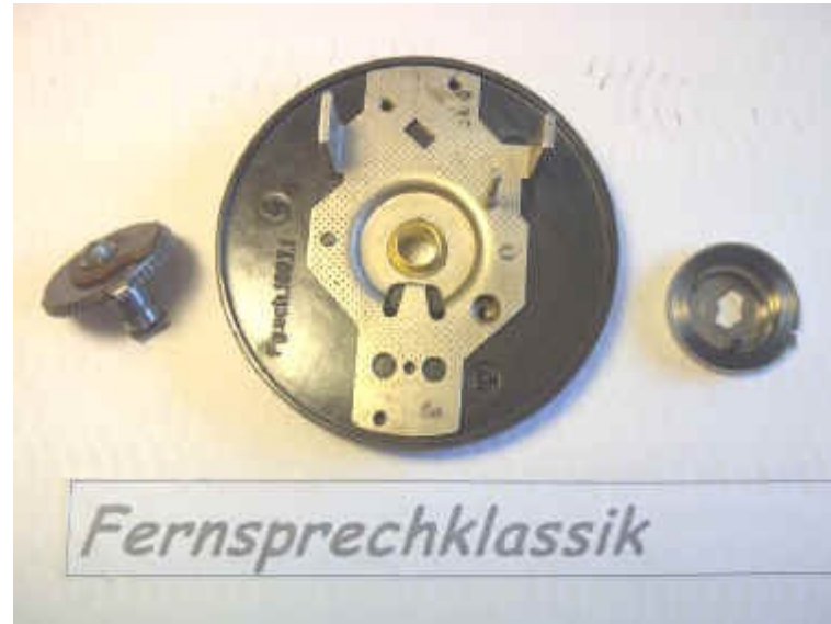
(Abb. 5: Großes Zahnrad mit sektorförmiger Pressstoffscheibe und Achse, Grund- und Trägerplatte miteinander verschraubt, Spann- und Rücklauffeder. Die Achse wird durch die auf diesem Foto sichtbare Seite der Metallträgerplatte gesteckt.)
