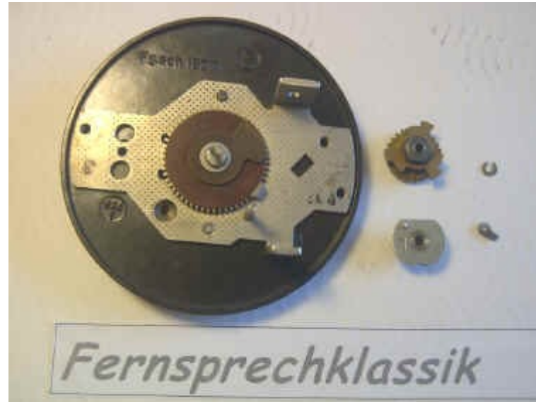
(Abb. 6: r.v.u. Schneckenrädchen mit Feder und Sperrhebel; r.v.o. dreiarmlige Stromstoßscheibe mit Schneckenrad fest verbunden und Sprengring)
