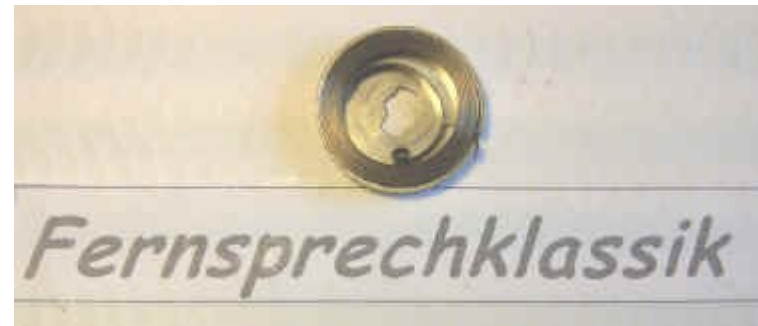
(Abb. 4: Die Schlaufe des Federendes wird im nächsten Schritt in die Nut der zylindrischen Achsführung der Metallgrundplatte "eingehängt".
