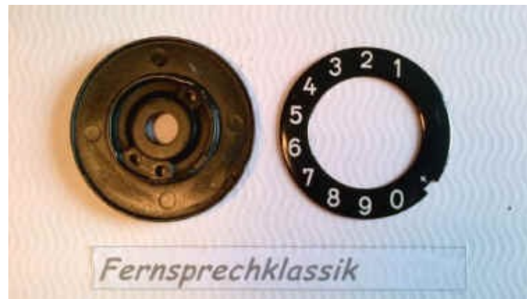
(Abb. 2: Grundplatte aus Bakelit; große, emaillierte Zifferscheibe)
